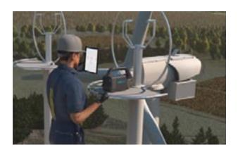
Das Übertragen der Richtung einer Generatorachse eines Windrades auf das Kabinendach: Diese komplizierte Richtungsübertragung kann mit dem LiPAD®-100 sehr schnell und genau übertragen werden. Alle anderen klassischen Messmethoden sind sehr aufwendig und nur von Experten durchführbar.
